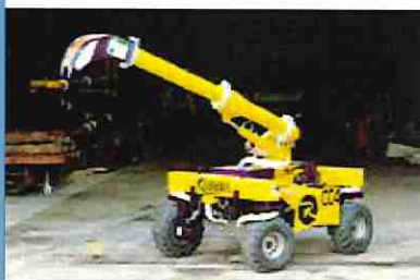
Le Concrete Cobra, le petit module de pompage adapté à tous les chantiers.
