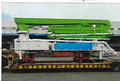
La Dy 33X-ZZ5 arrive pré-montée, prête pour son installation sur un porteur européen.
